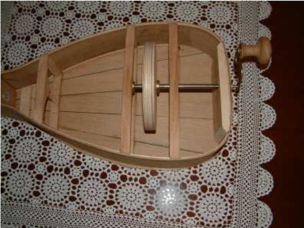
si vede molto chiaramente il Tallone del cantiere incollato al fondo e fasce nella parte anteriore della cassa qui fungera da rinforzo per la cordiera che altrimenti al primo tiro di corda si staccerebbe 😊 e come massa di fissaggio anche delle ancore per bordoni e corde di simpatia.
