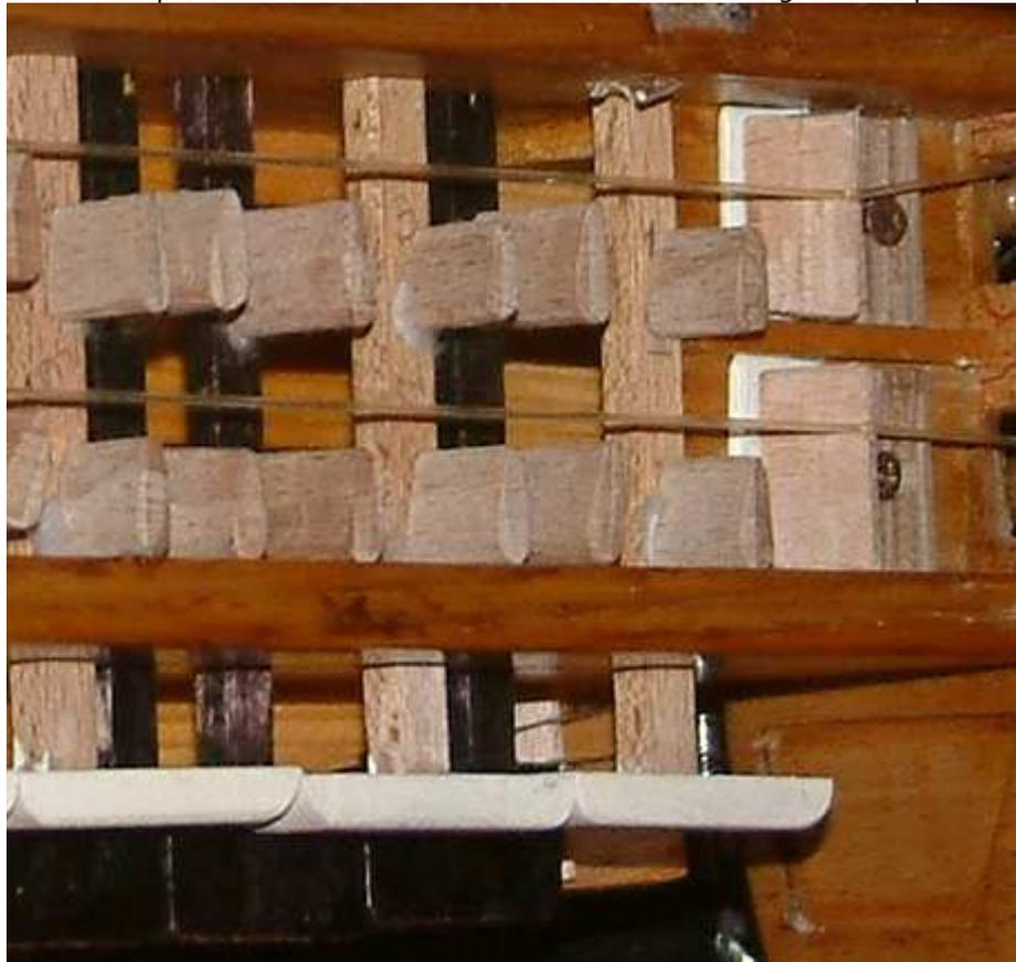
Nella foto si vede anche il capotasto che è di forma triangolare e alto quasi un centimetro, l'altezza precisa di questo non esiste perché poi in fase di accordatura io l'ho spessorato per fare in modo che la corda aderisca in modo regolare alla ruota, e poi deve essere anche scorrevole per permettere un'accordatura pratica.
