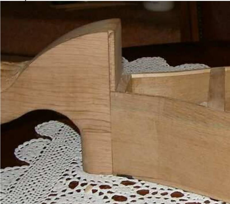
Il cavigliere inciso nei due lati come nella foto si inseriva poi da sopra come una giunzione a coda di rondine in seguito un bel vitone dall'interno della cassa armonica e colla naturalmente. Con il cavigliere di solito il creatore si puo sbizzarrire con la sua capacita di scultore vi sono parecchie foto di ghironde in rete e non ce ne è uno uguale all'altro di solito si mette un volto femminile ma c'e chi si accontenta di un ricciolo o fa pure una testa animale
